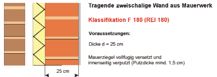
Abb. 8: Ausführungsbeispiel einer tragenden zweischaligen Wand aus Mauerwerk
