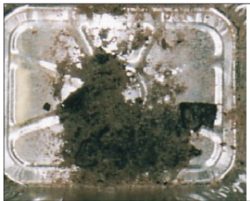
Abb. 14: Probekörper nach dem Glimmbrandversuch bei 250 °C Ofentemperatur
